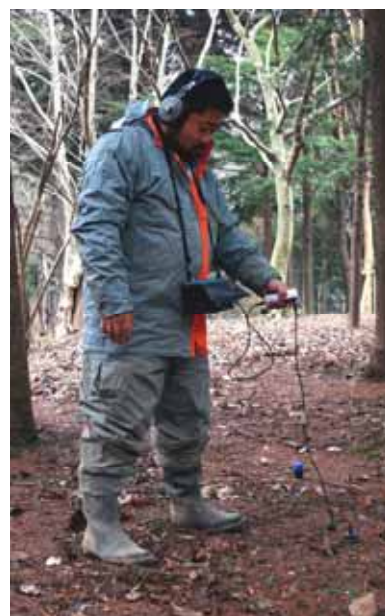
写真-5 地下流水音を測定している様子
